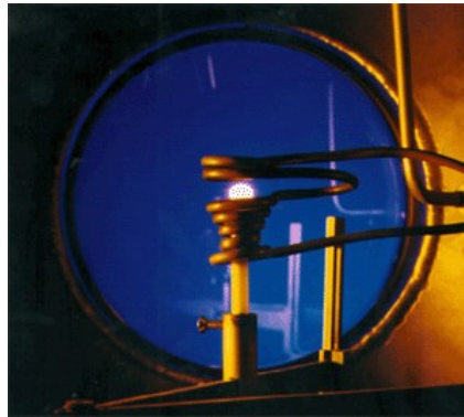
FIGURE 2.2 – Forme typique d'une bobine utilisée pour la lévitation électromagnétique.
