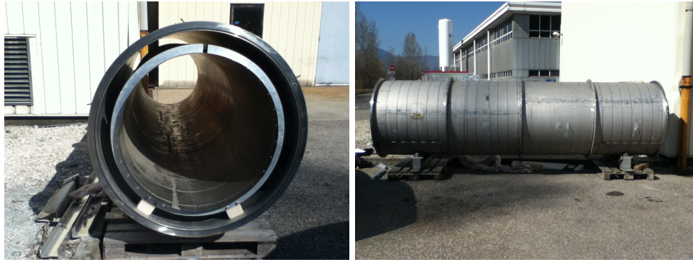
FIGURE 4.3 – Blindage magnétique utilisé dans notre expérience. Le cylindre intérieur est constitué de \mu -métal, le cylindre extérieur est en aluminium.
