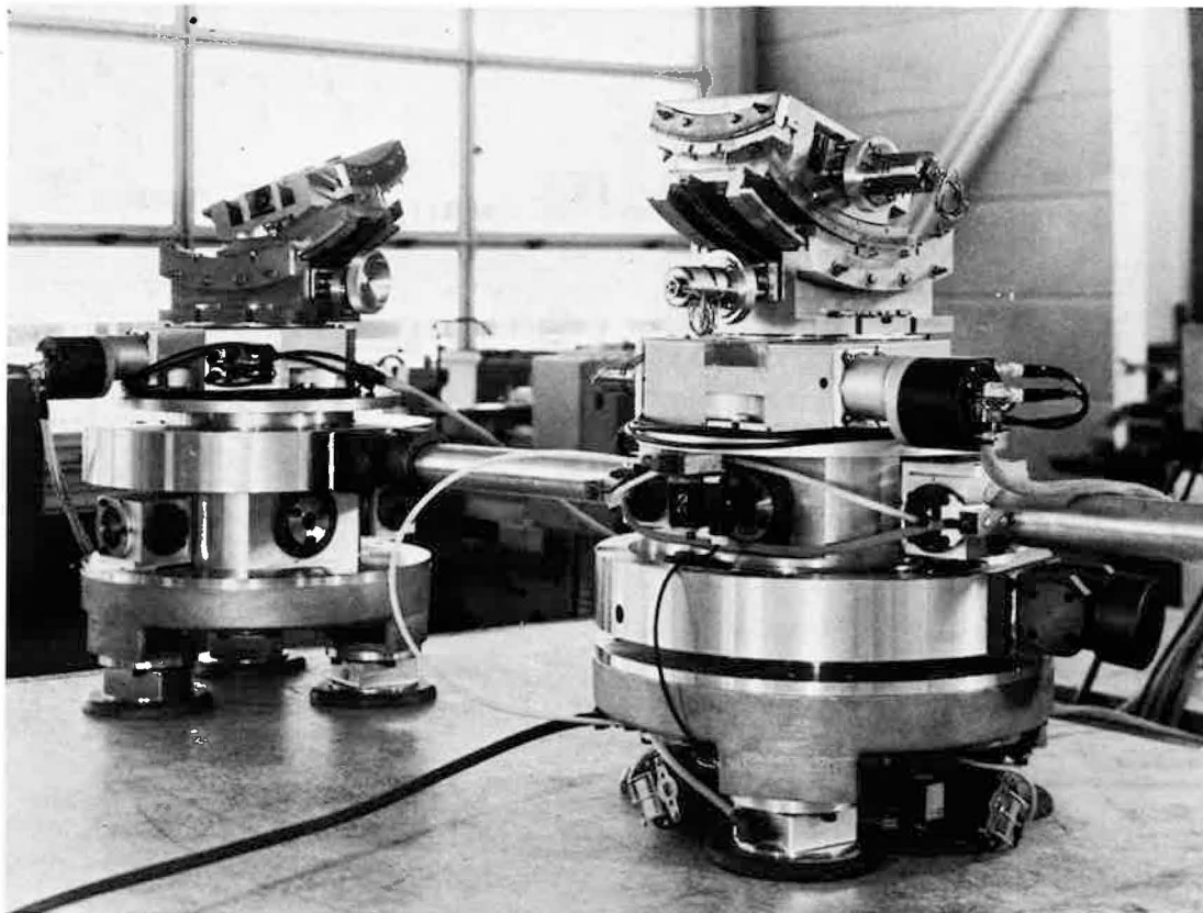
Figure 7 : Montage de deux tables tanzboden munies d'un équipement d'orientation du cristal
