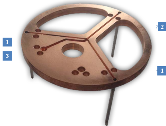
Figure 3.24 : Bloc de distribution du gaz du détecteur SECOND
