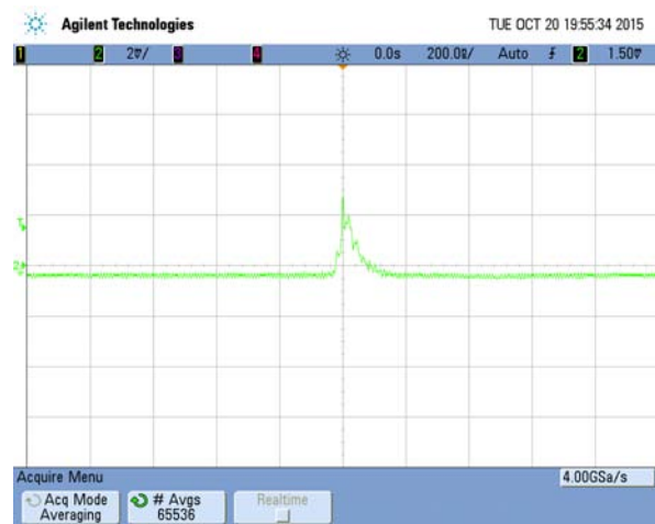
Figure 4.9 : Signal moyen généré par un électron créé par excitation thermique (amplifié x3)
