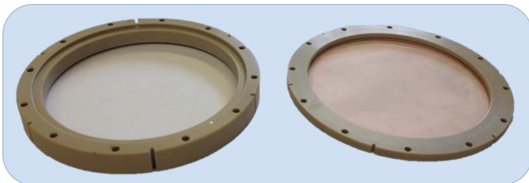
Figure 3.23 : Vue de dessous des parois du volume d'induction de la chambre gazeuse
