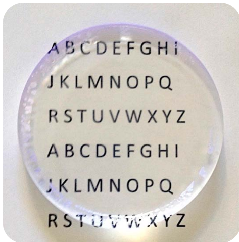
Figure 4.3 : Photographie du phoswich après polissage
