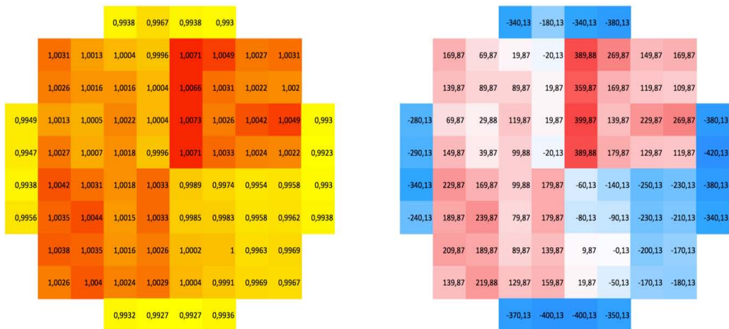
Figure 6.8 : Mappage de la tension d'opération conseillée par Hamamatsu de chaque MPPC
