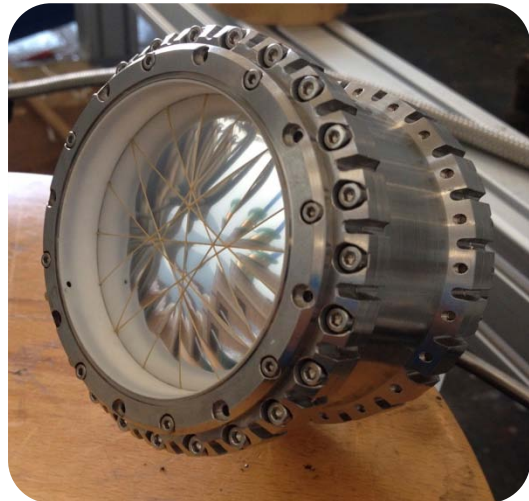
Figure 4.14 : Test de la résistance d'un second réseau de fibres de Kevlar® à 350 mbar
