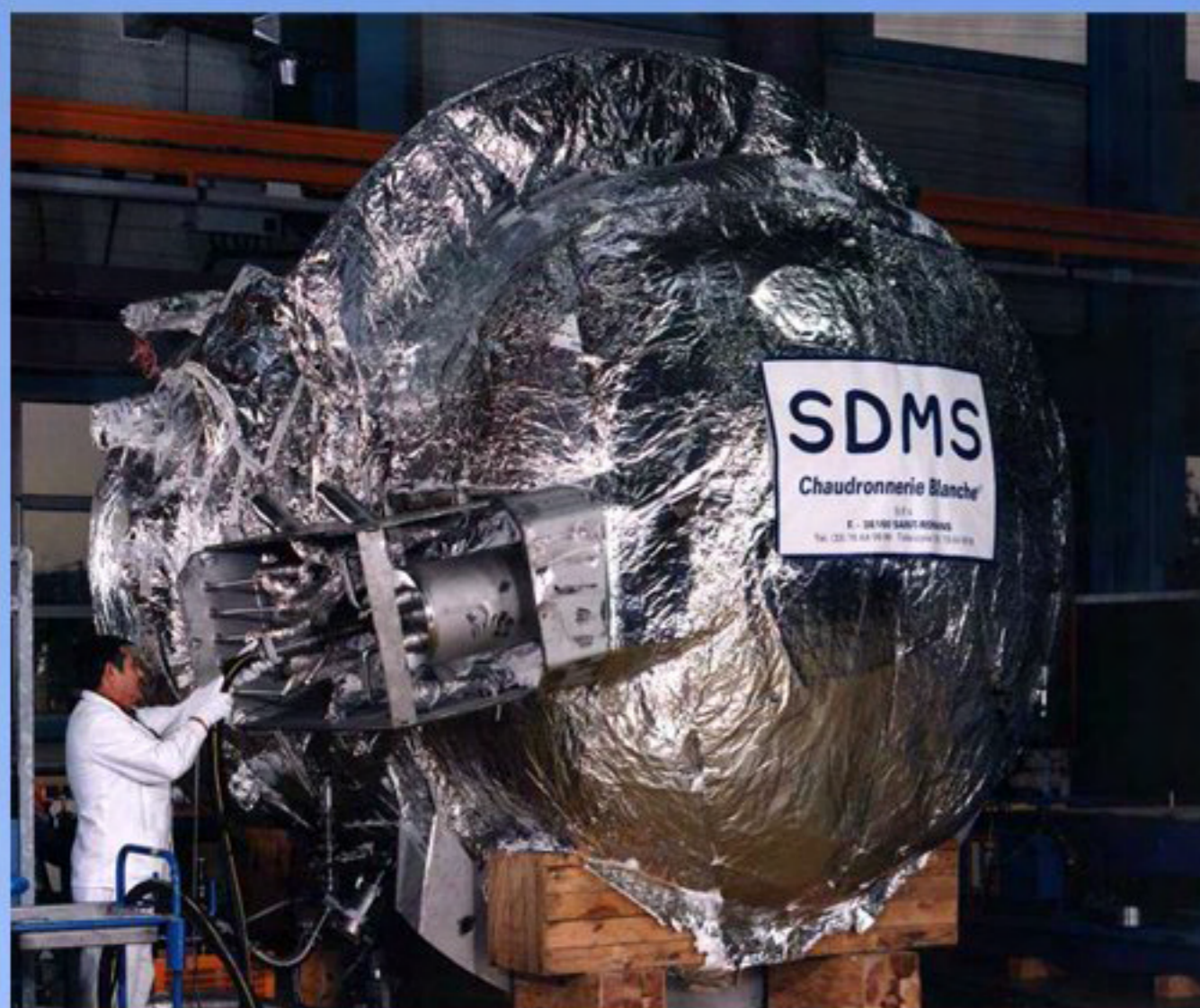
Client : Air liquide. Réservoir de stockage d'oxygène liquide pour sous-marin. 15 m 3
