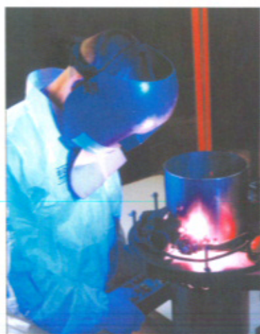
Soudure à tête orbitale – Orbital GTAW
