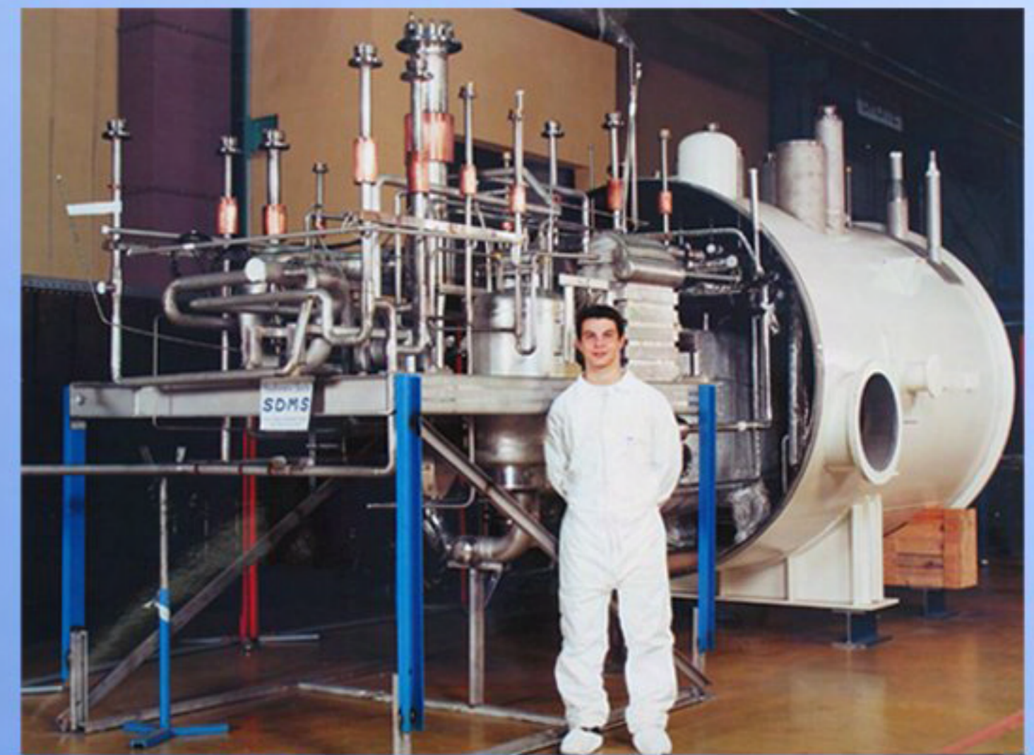
Client : CENG Réfrigérateur 400 W Température 1,8 °K
