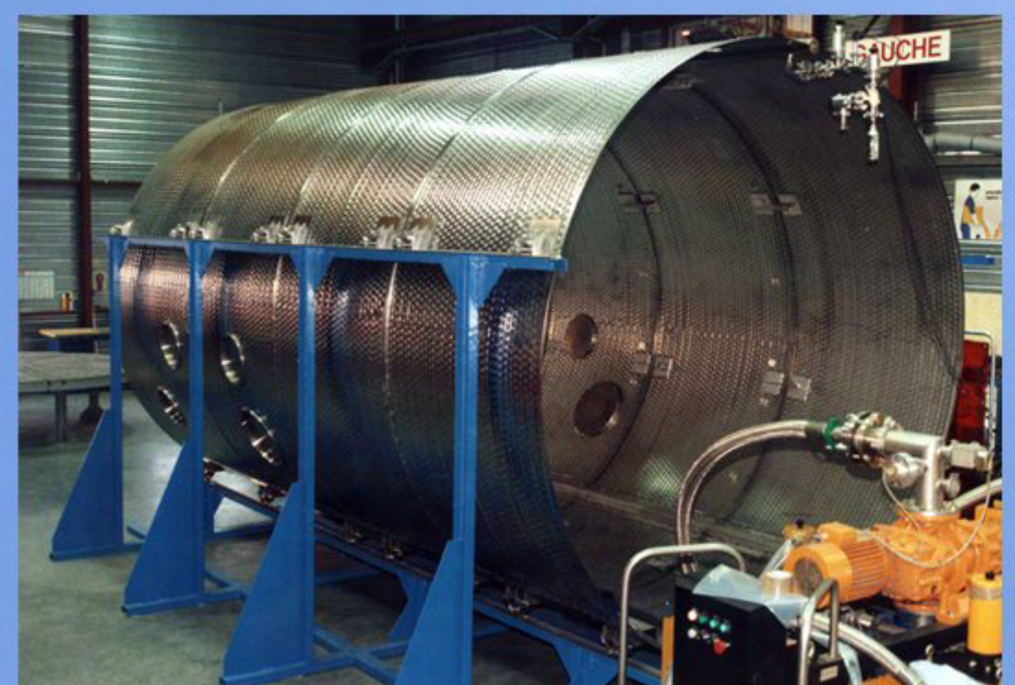
Client : Alcatel Space Peau froide pour caisson de simulation.
