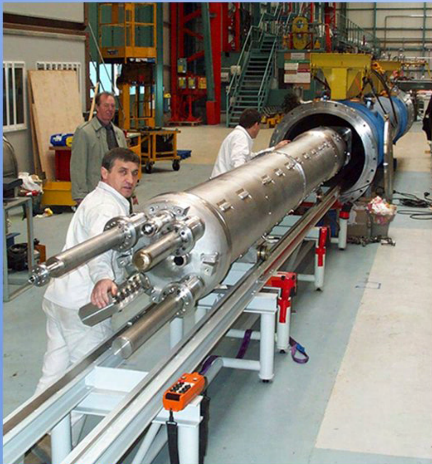
Client : CERN Masse froide pour LHC Pression : 20 bars, température : 1,9 °K.
