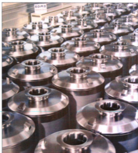
Conteneurs pour atelier de vitrification
