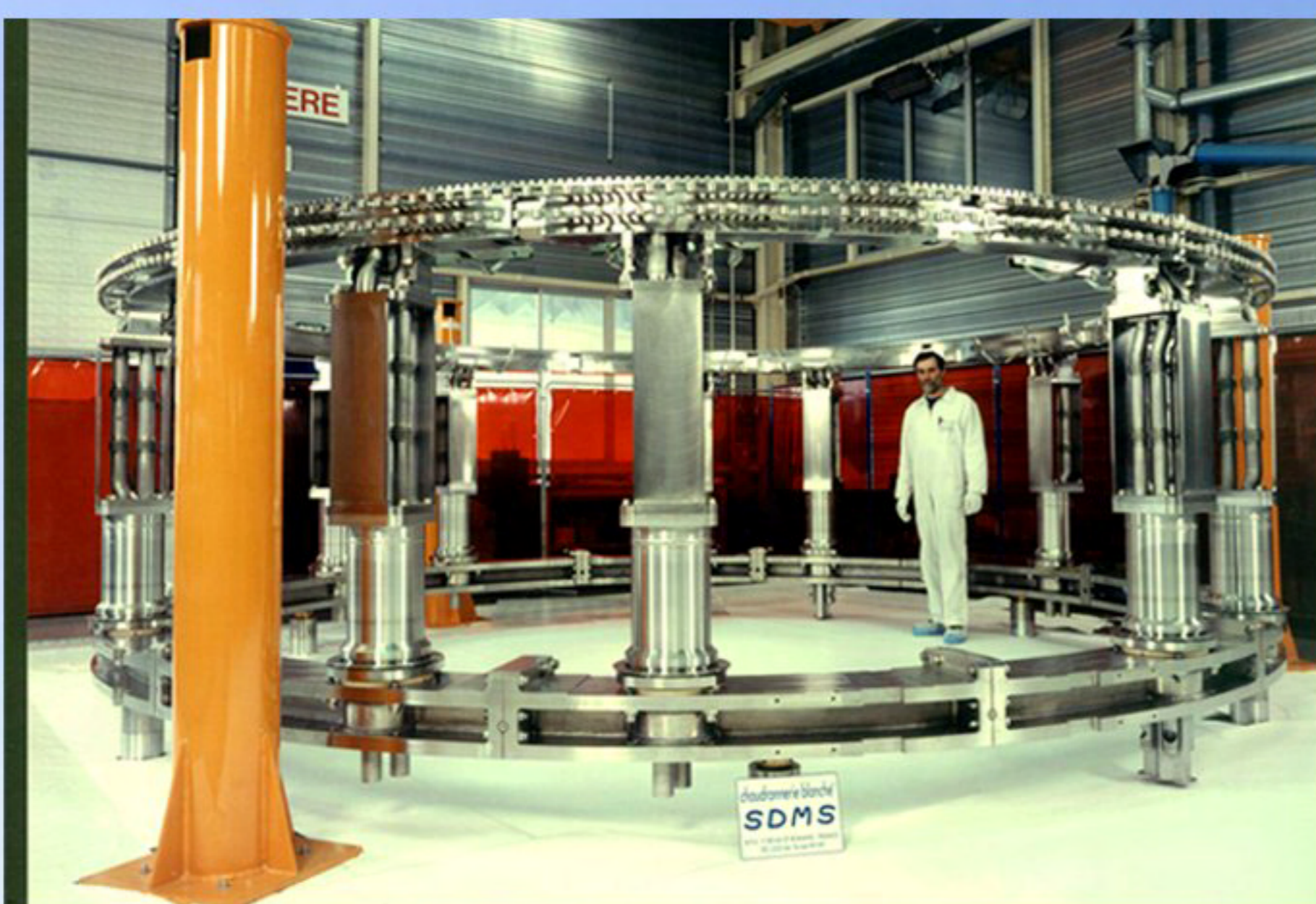
Client : CEA Cadarache. "TORE SUPRA" Structure porteuse du LPT Diamètre : 5200 mm, Tolérances : 0,1 mm
