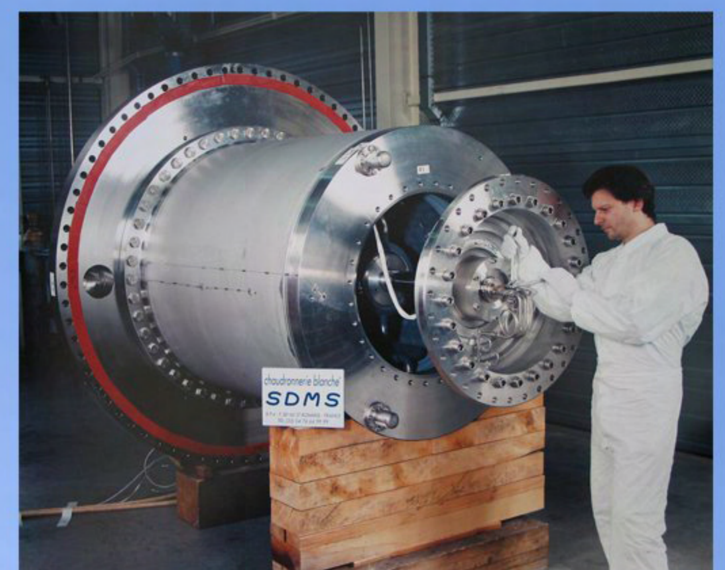
Client : Air liquide. Pompe cryogénique pour le projet ITER UNS S30403 (Z3CN1810)
