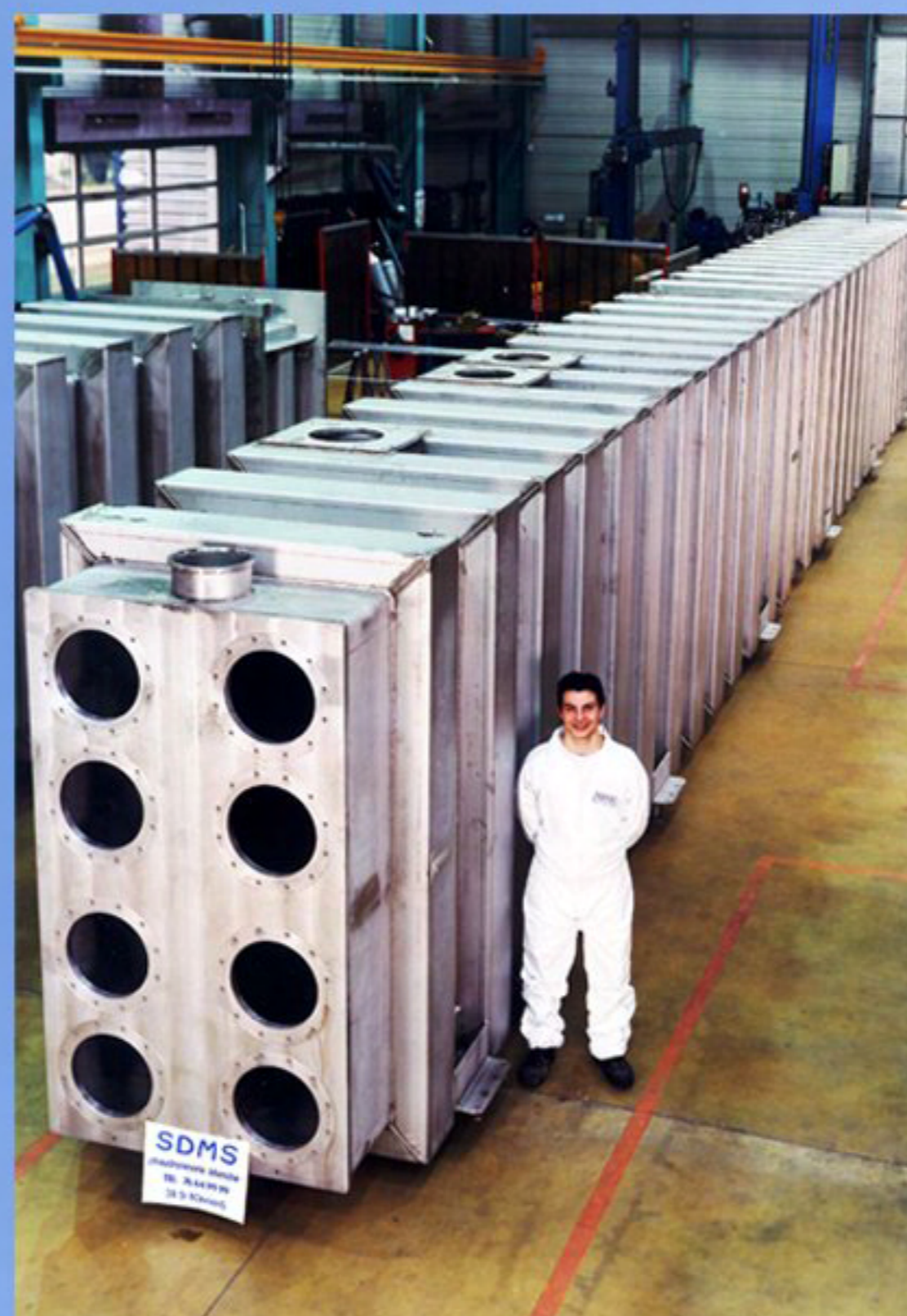
Client : CEA/CESTA 6m/20m long Vacuum Chambers Grandes chambres à vide pour Projet LIL / LMJ.
