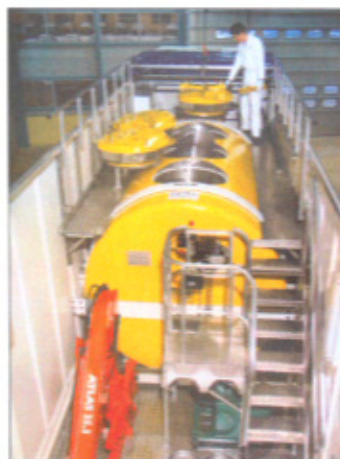
Ensemble routier LR56 B(U) : 4 m 3 , 50 mm Pb
