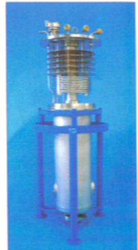
Cryostat LN2 65^{\circ}\text{K}
